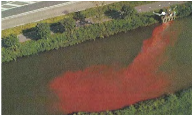
FOTO 1 EFFLUENTPLUIM VAN DE RWZI KATWOUDE, 10 MINUTEN NA START VAN DOSERING VAN EEN KLEURSTOF (GHAUHARALI EN BOS, 2007)
