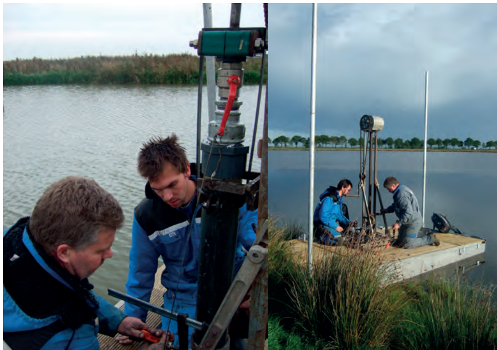
FIGUUR 5.2 MONSTERNAME VAN ONVERSTOORDE SEDIMENTKOLommen. DE KOLOMMEN WORDEN AAN EEN STANG HET SEDIMENT INGEDUWD EN ONDER VACUÛM OMHOOG GEHAALD.
