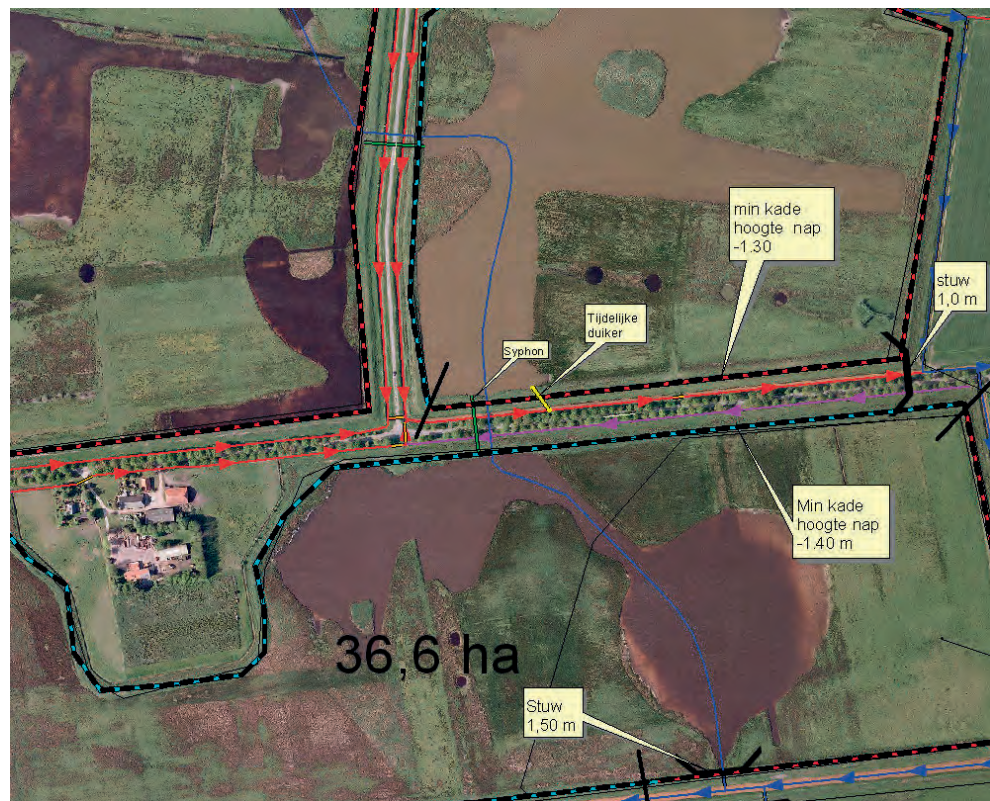
FIGUUR 4.6 WATERAFVOER WOUDBLOEM. DE DOORGETROKKEN BLAUWE LIJN GEEFT DE REGULIERE WATERAFVOER WEER. DE KORTE GELE LIJN IS DE TIJDELIJKE NOODAFVOER.
