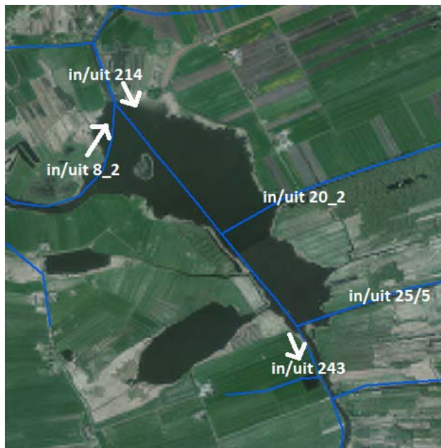
Figuur 34 Codes van de balansposten voor het Giethoornse Meer. De belangrijkste in- en uitlaten aangegeven met pijl.
