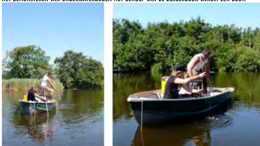
FIGUUR 5.4 HET BEMONSTEREN VAN ONDERWATERBODEM MET BEHULP VAN DE ZUIGERBOOR VANUIT EEN BOOT.
