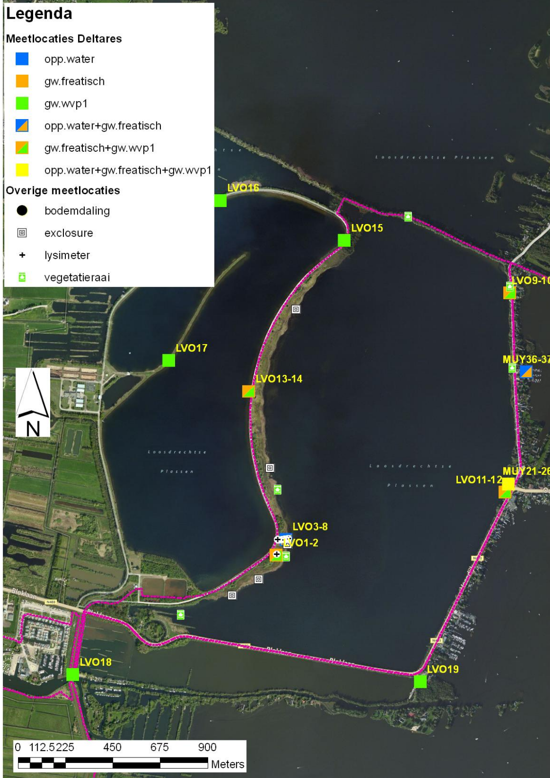
Figuur 4.3 Meetopstelling in Flexpeil pilotgebied Loenderveen-Oost: locaties van peilbuizen, lysimeters, vegetatieopnames en exclusures.
