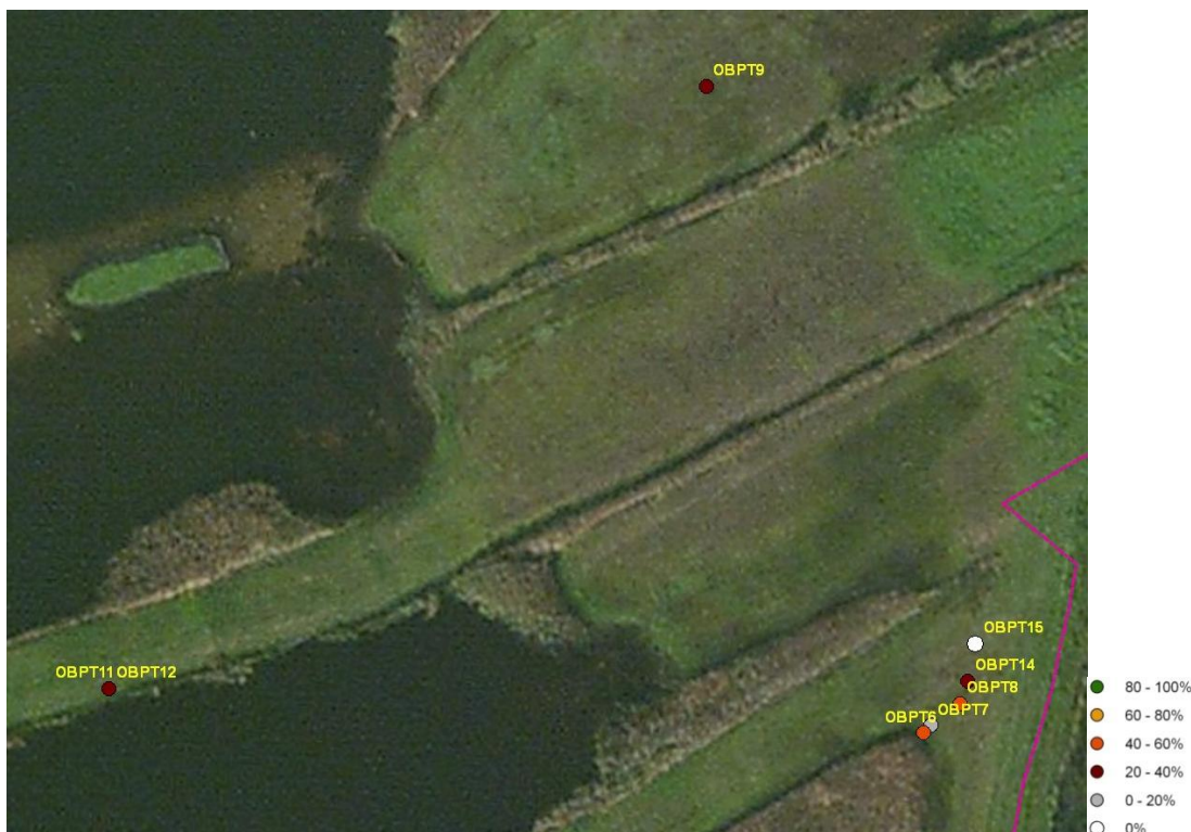
Figuur 3.5 Percentage verklaard door oppervlaktewater in de Oostelijke Binnepolder van Tienhoven.
