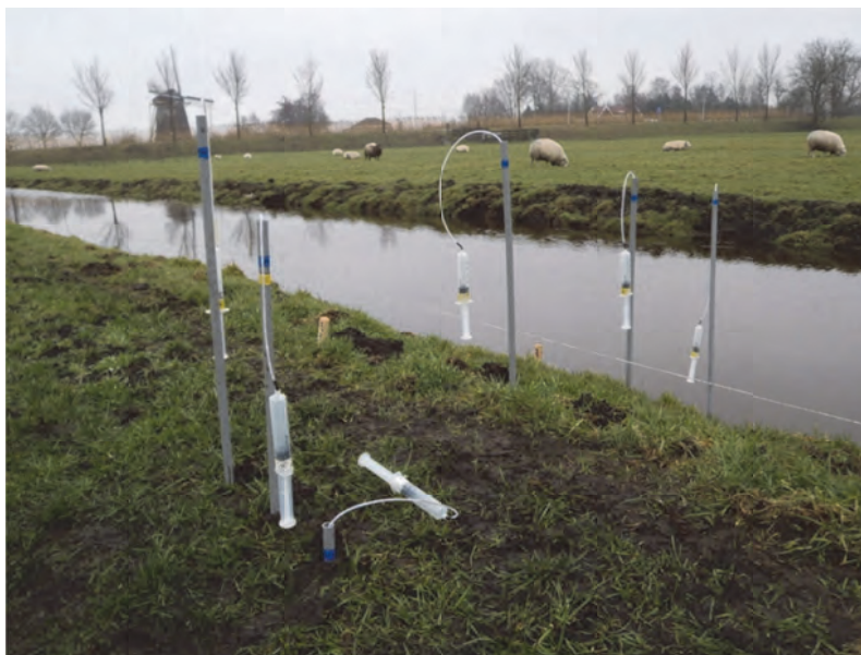
Figuur 2.2.1 Raai van bodemwaterbemonsteraars uitgezet vanuit de sloot naar het weiland. De bemonsteraars staan op 25 cm diepte. Op het hoogste punt in het weiland zijn tevens op dezelfde afstand van de oever bemonsteraars geplaatst op 50 en 100 centimeter diepte.
