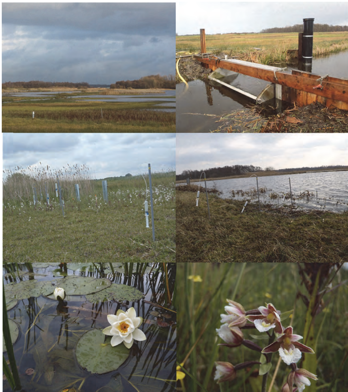
Figuur 4.7.1 De Oostelijke Binnenpolder van Tienhoven.. Linksboven, Overzichtsfoto van het gebied. rechtsboven Stuw bij één van de uitlaatpunten. Midden Oevergradiënten met peilbuizen en poreuze cups ten behoeve bodemwaterbemonstering (links raai A en rechts raai D). Onder: Links waterplantenvegetatie met Waterlelie en Glanzend Fonteinkruid. Rechts Moeraswespenorchis bij Raai A.
