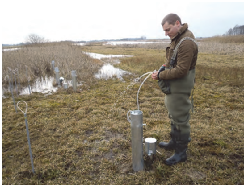
Figuur 2.2.2 Leegpompen van peilbuizen van het ‘oude’ grondwater, dat in de buizen heeft gestaan. Hierna wordt het ‘vers’ toestromende grondwater bemonsterd voor verdere analyse.
