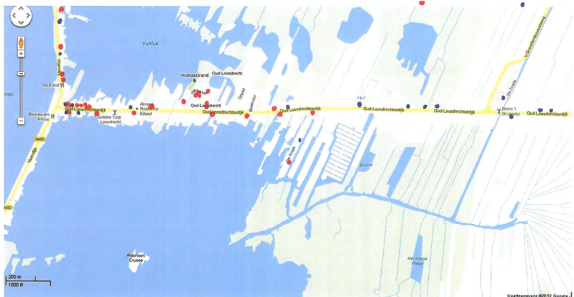
Figuur 2.10 Funderingen op staal (rode stip) en funderingen op houten palen in Noord-Oost Muyevelde
