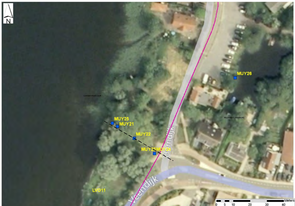
Figuur 4.4 Locatie geplaatste peilbuizen raai Horndijk (Oud-Loosdrechtse dijk)
