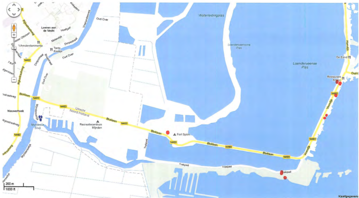
Figuur 2.9 Funderingen op staal (rode stip) en funderingen op houten palen in Noord-West Muyevelde
