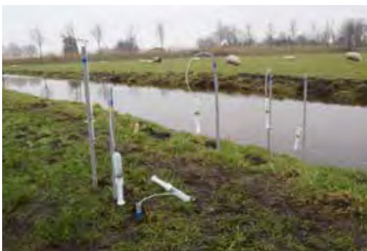
RAAI MET LYSIMETERS VOOR PORIEVOCHTMETINGEN.
