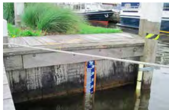
MUYVELD: MEETOPSTELLING PARTICIPATIEF MEETNET. LINKS PEILSCHAAL, RECHTS PEILBUIS.
