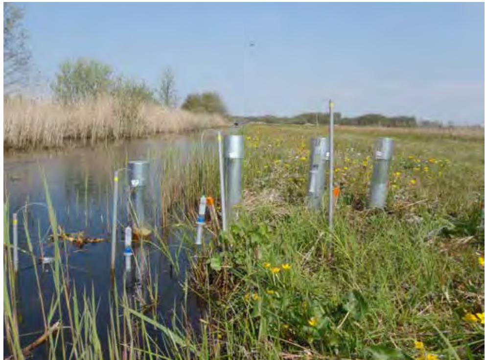
AFBEELDING 8.3.1 RAAI MET PEILBUIZEN EN LYSIMETERS VOOR BODEMVOCHT VANAF HET OPEN WATER DE OEVER OP.
