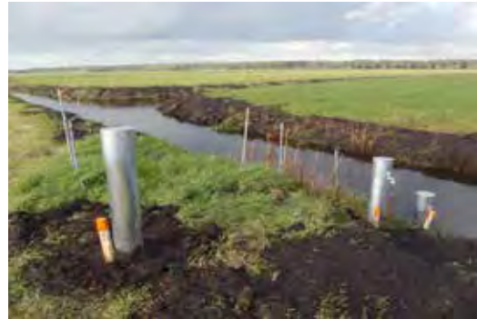
RAAI VAN GRONDWATERPEILBUIZEN (METALEN KOKERS) IN COMBINATIE MET LYSIMETERS VOOR BODEMVOCHT-METINGEN VANAF DE OEVER HET PERCEEL OP.
