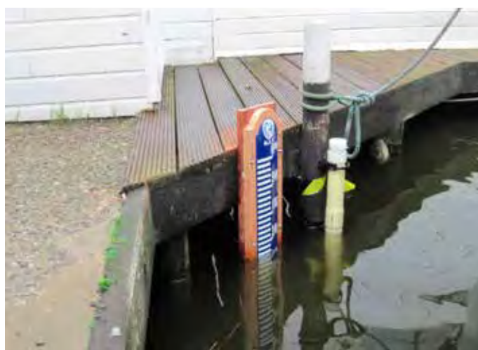
AFBEELDING 31.X MEETOPSTELLING. LINKS: PEILSCHAAL EN RECHTS: OPPERVLAKTEWATERPEILBUIS.
