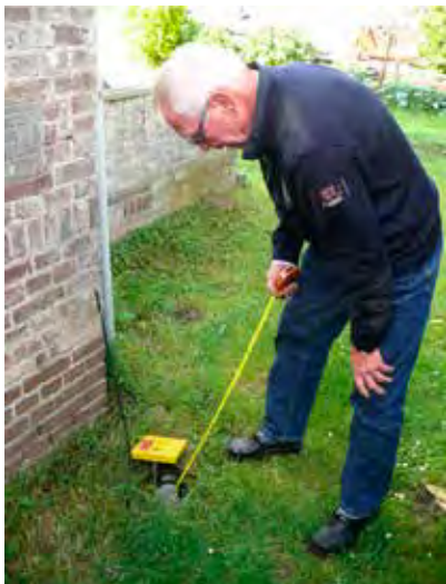
AFBEELDING 31.X HANDMATIGE METEN VAN DE GRONDWATERSTAND DOOR DEELNEMER AAN HET PARTICIPATIEF MEETNET.
