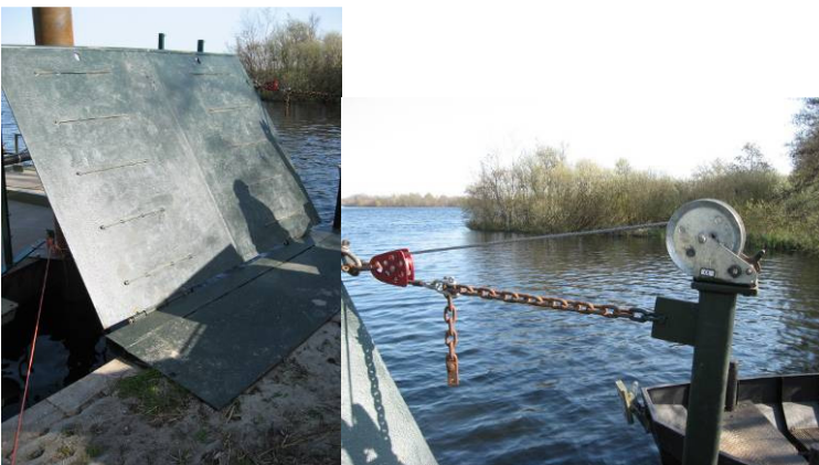
Afbeelding 3-3: Metalen plaat met lier
