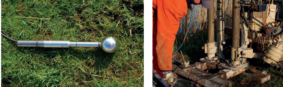
FIGUUR 42 BOLSONDE 78MM (LINKS) EN UITVOERING OP OUELANDSDIJK (RECHTS) (BRON: J.KAMES)
