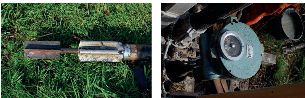
FIGUUR 43 VINBLAD 65MM X 130MM (LINKS) EN ROTATIE APPARAAT GEONOR (RECHTS) (BRON: J.KAMES)
