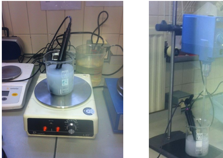
FIGUUR 1 OPSTELLINGEN VOOR BEPALING VAN DE RIJPINGSTIJD. BIJ OPSTELLING 1 WERD EEN ROERVLO GEBRUIKT VOOR DE MENGING. BIJ OPSTELLING 2 EEN MECHANISCHE BOVENROERDER
