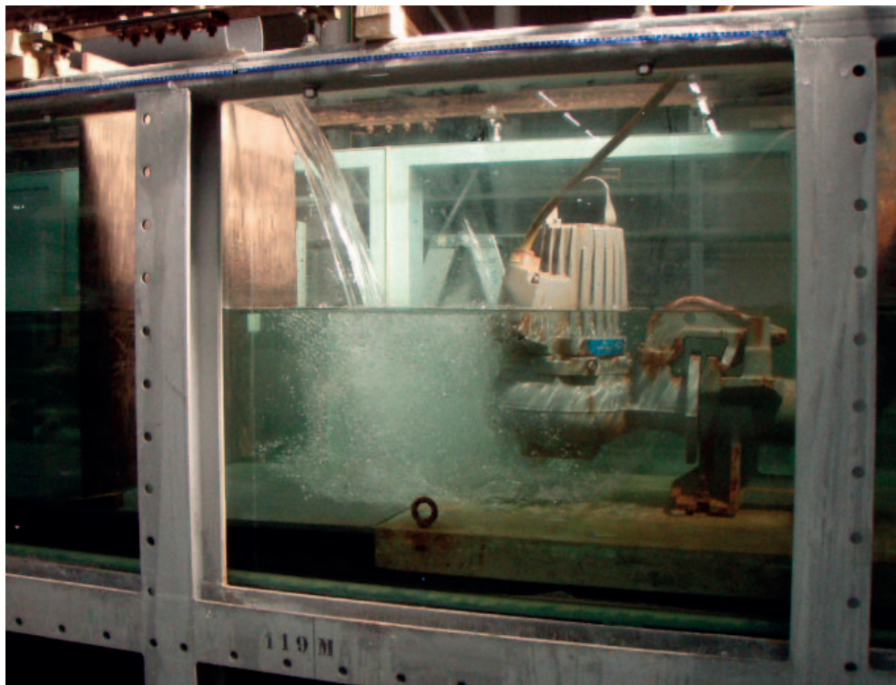
FIGUUR A.19 FOTO VAN DE PROEFOPSTELLING VAN KRANENDONK (2007). DE LUCHTBELLEN WORDEN DE POMP INGEZOGEN.
