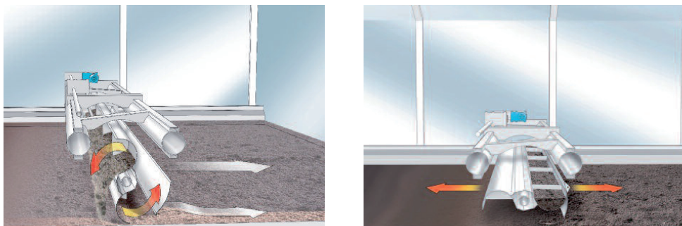
HUBER SYSTEEM, LINKS HET OPWERKEN VAN HET SLIB EN RECHTS HET VERPLAATSEN VAN HET SLIB DOOR DE KAS
