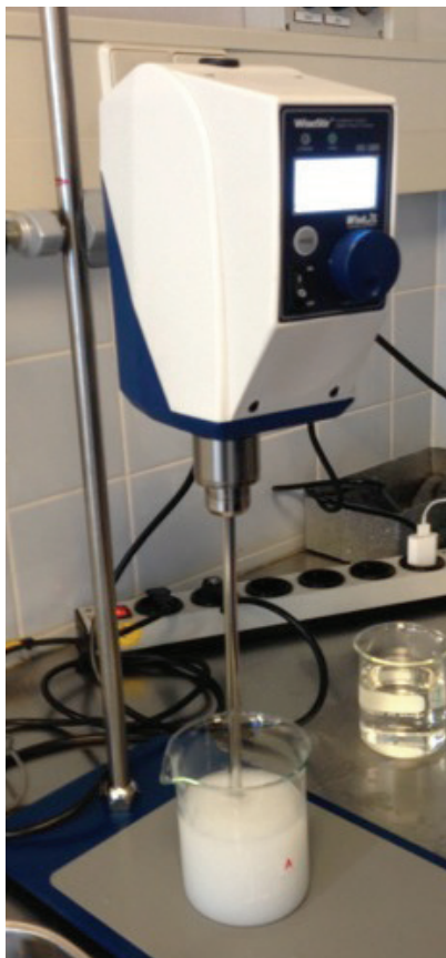
AFBEELDING 1 TESTOPSTELLING VOOR RIJPINGSPROEVEN OP LABORATORIUMSCHAAL
