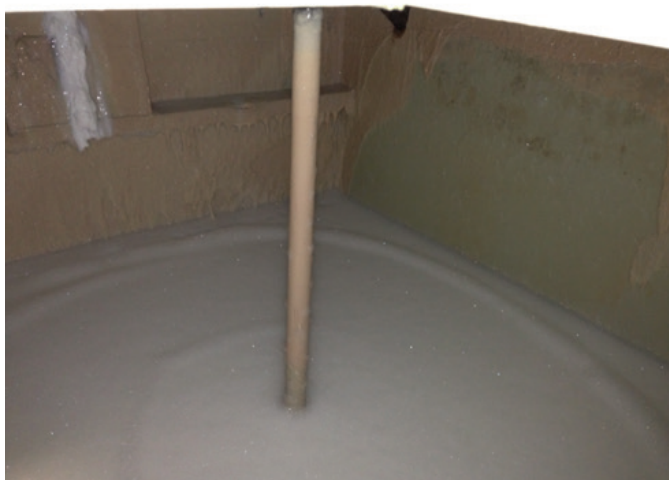
AFBEELDING 21 NIVEAU IN DE TANK A3720 II WAARBIJ DE VISCOSITEIT BEGINT OP TE LOPEN
