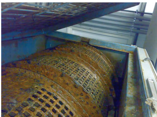
FIGUUR 3.2 RBC REACTOR VOOR HET OLAND PROCES
