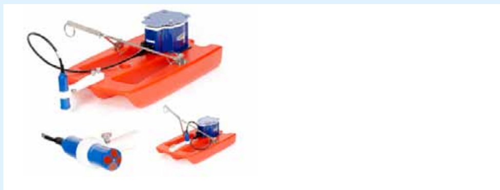
Voorbeeld akoestisch meet-instrument (ADCP) op een boot
