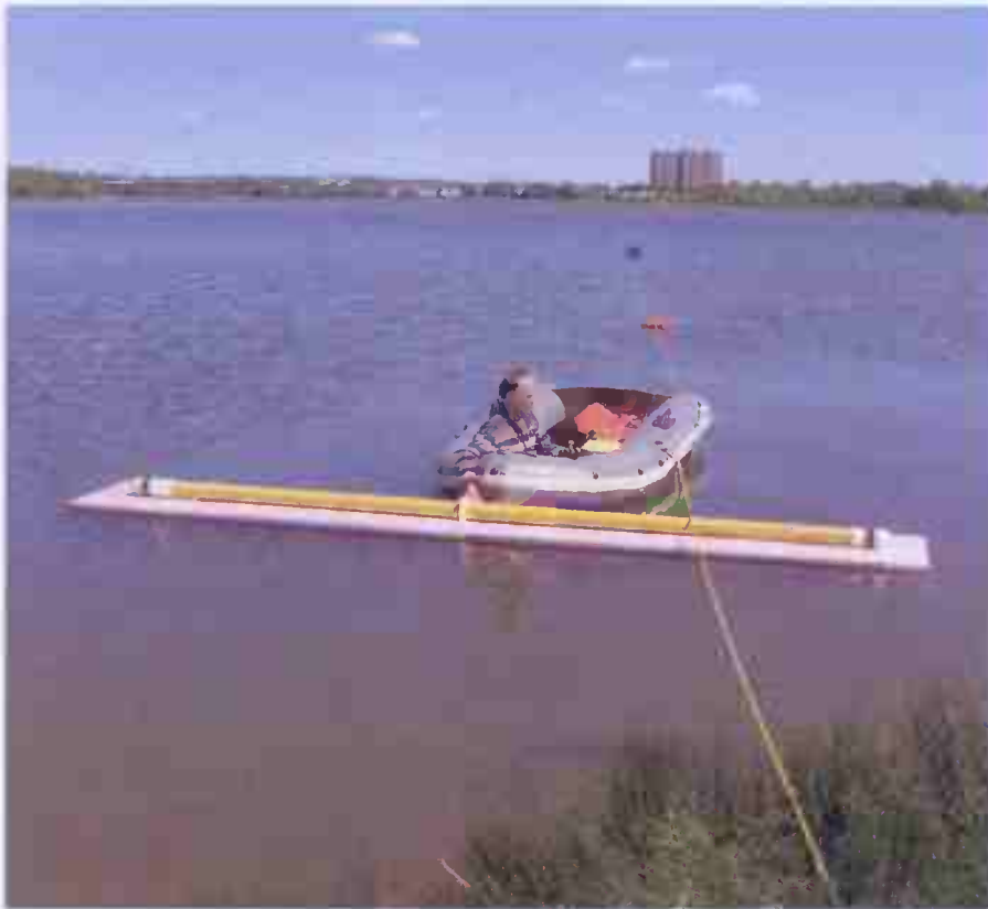
Figuur 2.5 Gebruik van een EM apparaat op water (DUALEM 421S).
