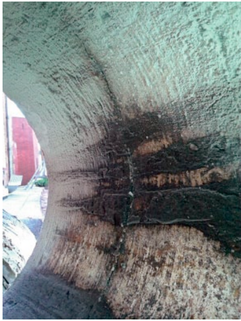
Figuur 3.6 Foto's gebroken persleiding: buitenkant (links) en binnenkant (rechts)
