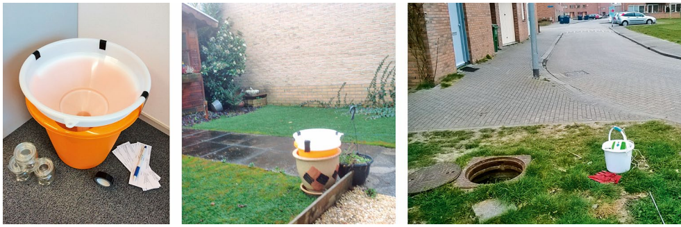
Figuur 8.5 Meetemmer voor hemelwatermonsternamen (links), opstelling meetemmer in tuin medewerker gemeente (midden) en bemonstering uit hemelwaterstelsel vlak vóór bui (rechts)
