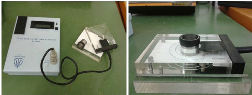
OPSTELLING CST-TEST MET EEN 304B CST VAN TRITON ELECTRONICS LTD
