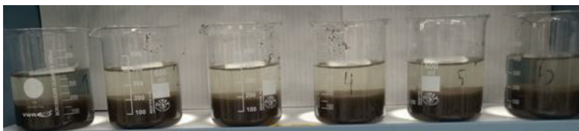
AFBEELDING 32 JARTEST (JT30) MET SLIB VAN RWZI AMSTERDAM. BEKERGLAS 1 & 6: 100% PE, BEKERGLAZEN 2-5: 75% PE. BIJ GLAS 3,4 EN 5 OPLOPENDE DOSERING CYCLODEXTRINE: 0,25; 0,5 EN 1,0 G/KG DS.
