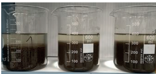
AFBEELDING 29 JARTEST (JT14) MET SLIB VAN RWZI AMSTERDAM. BEKERGLAS 1: NORMAAL PE, BEKERGLAS 2: CH1, BEKERGLAS 3: CH2. ALLE BEKERGLAZEN HEBBEN EEN GELIJKE DOSERING (100% = 7 G/KG DS).
