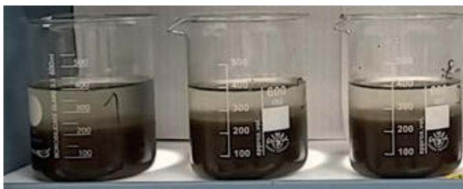
AFBEELDING 29 JARTEST (JT14) MET SLIB VAN RWZI AMSTERDAM. BEKERGLAS 1: NORMAAL PE, BEKERGLAS 2: CH1, BEKERGLAS 3: CH2. ALLE BEKERGLAZEN HEBBEN EEN GELIJKE DOSERING (100% = 7 G/KG DS).
