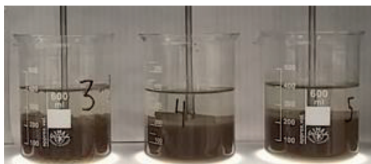
AFBEELDING 24 JARTEST (JT19) MET SLIB VAN RWZI DRONTEN. BEKERGLAS 3: NORMAAL PE, BEKERGLAS 4: TA1, BEKERGLAS 5: TA2. ALLE BEKERGLAZEN HEBBEN EEN GELIJKE DOSERING (100% = 4 G/KG DS).
