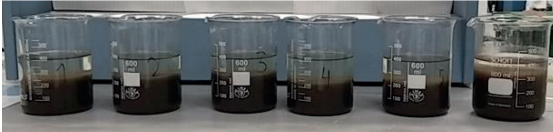
AFBEELDING 23 JARTEST (JT11) MET SLIB VAN RWZI AMSTERDAM. BEKERGLAS 1: NORMAAL PE, BEKERGLAZEN 2-6: VERSCHILLENDE KATIONISCHE ZETMELEN. ALLE BEKERGLAZEN HEBBEN EEN GELIJKE DOSERING (100% = 7 G/KG DS).
