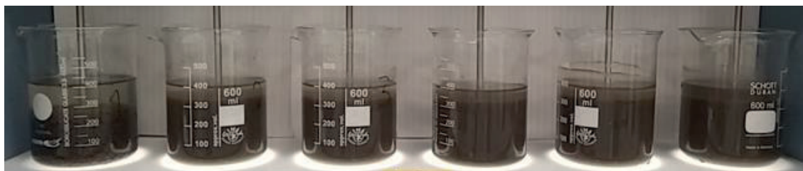
AFBEELDING 26 JARTEST (JT8) MET SLIB VAN RWZI AMSTERDAM. BEKERGLAS 1: NORMAAL PE, BEKERGLAZEN 2-6: VERSCHILLENDE KATIONISCHE TANNINES. ALLE BEKERGLAZEN HEBBEN EEN GELIJKE DOSERING (100% = 7,0 G/KG DS).
