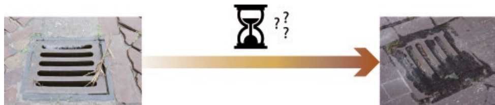
Figuur 4.1 Van een werkende kolk naar een verstopte kolk
