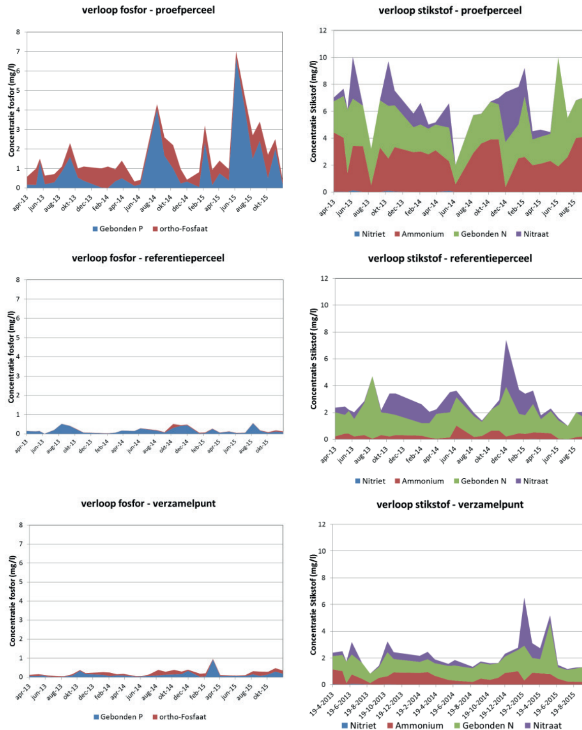
FIGUUR 3.8 VERLOOP VAN DE FRACTIES P EN N IN HET OPPERVLAKTEWATER VAN HET PROEFPERCEEL, HET REFERENTIEPERCEEL EN HET VERZAMELPUNT.
