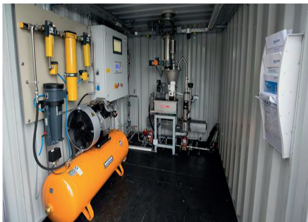
AFBEELDING 3.10 PACAS POEDERKOOLOTESTOPSTELLING RWZI PAPENDRECHT (RHDHV)
