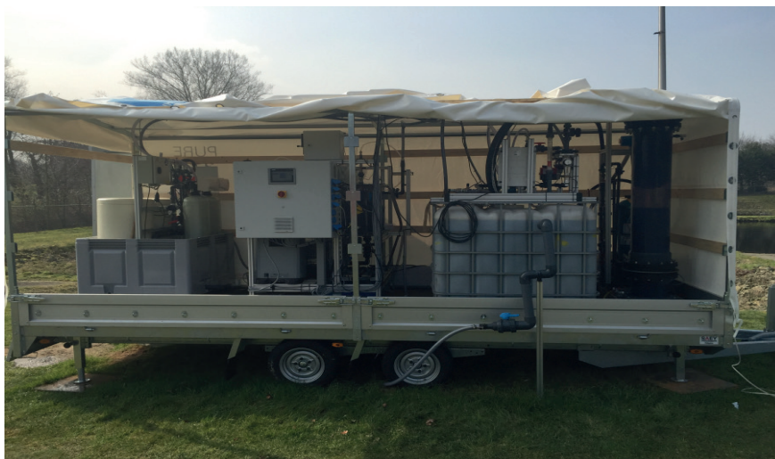
AFBEELDING 3.7 TESTLOCATIE RWZI PANHEEL IONENWISSELING + UV/H2O2 (PUREBLUE)
