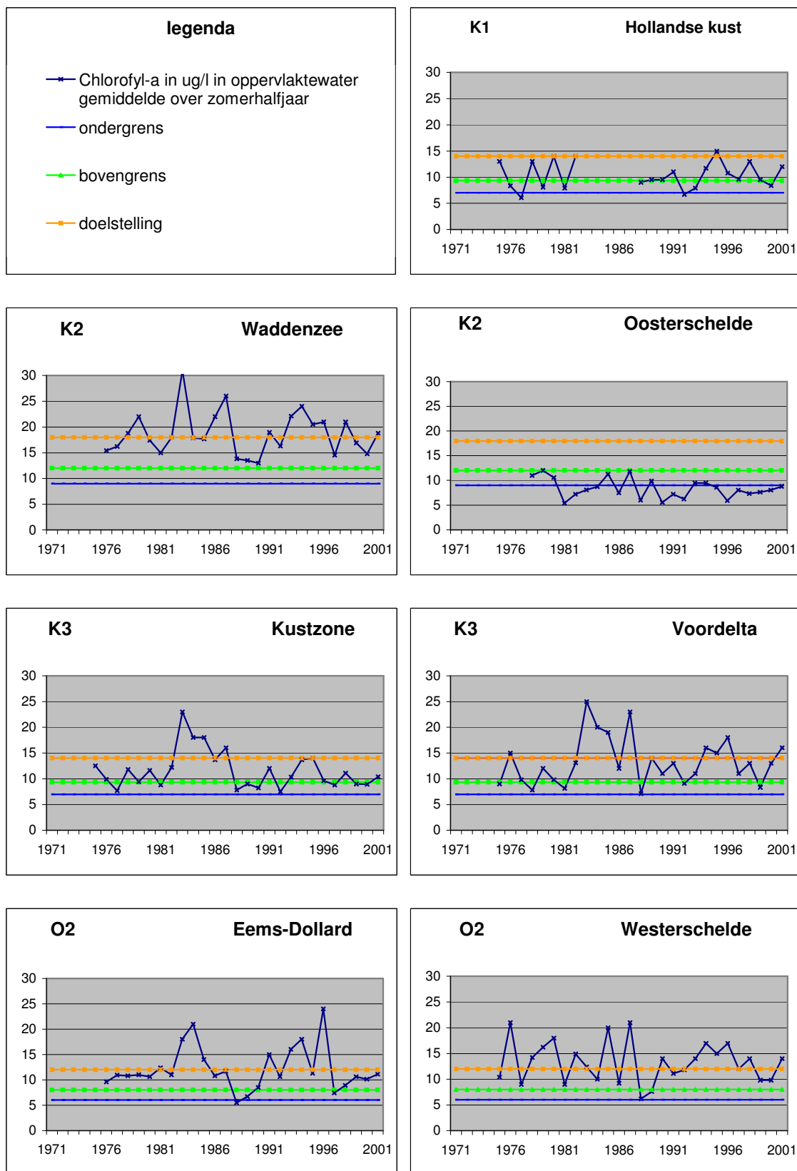
FIGUUR 2.2 GEMIDDELDE ZOMERWAARDEN VAN DE CHLOROFYL-A CONCENTRATIES IN DE NEDERLANDSE KUST- EN OVERGANGSWATEREN, MET ONDER- EN BOVENGRENS VAN DE REFERENTIEWAARDEN EN MET DE DOELSTELLING (OVERGANG TUSSEN GOEDE EN MATIGE TOESTAND), DIE 50% BOVEN DE BOVENGRENS LIGT.
