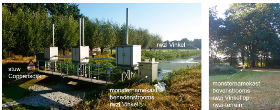
Figuur 4.6 Twee monsternamekasten rondom lozingspunt rwzi Vinkel in Groote Wetering: benedenstrooms bij stuw Coppensdijk (links) en bovenstrooms op rwzi-terrein (rechts)
