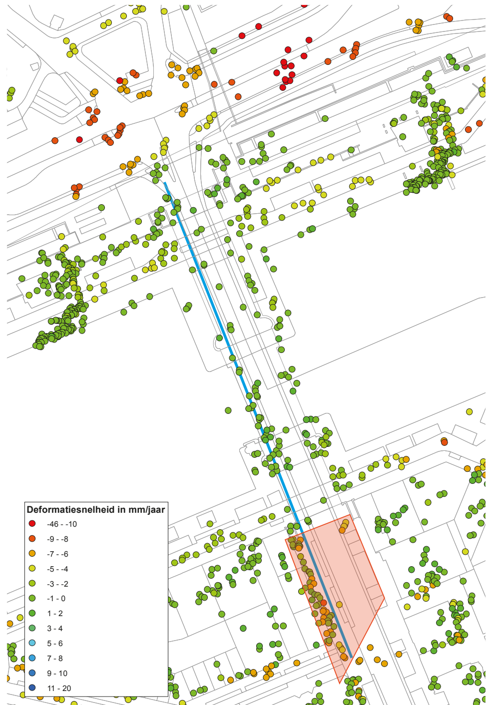
Figuur 3.16 Zettingskaart op basis van satellietmetingen: leiding in bruggenhoofd bij overgang onderheid-niet onderheid
