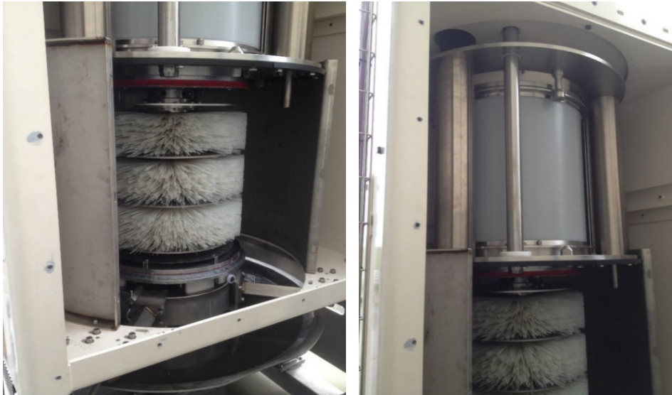
FIGUUR 3.2 BINNENKANT BORSTELCENTRIFUGE (LINKS), TROMMEL (RECHTS)
