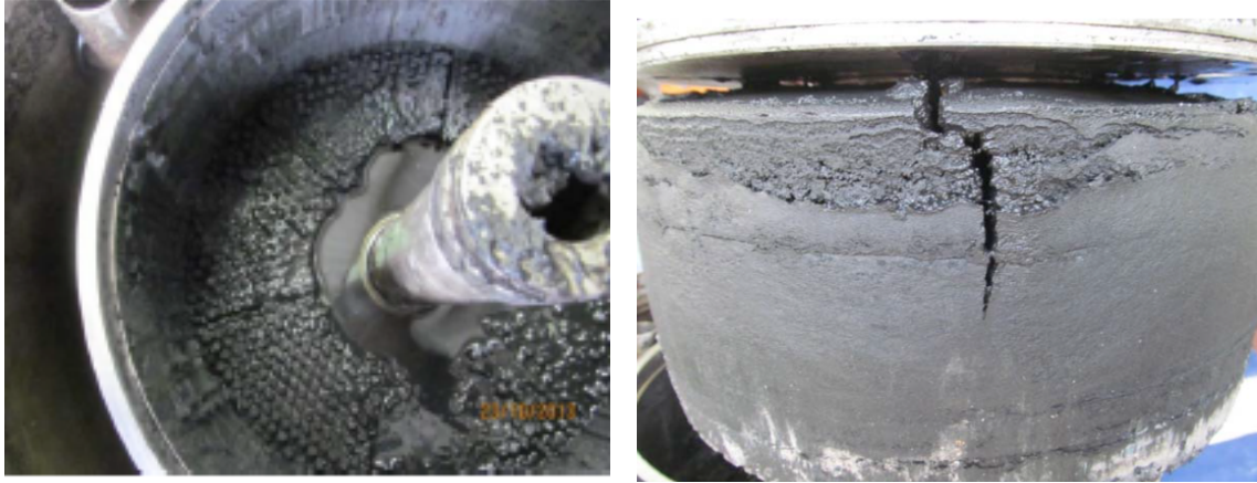
FIGUUR 2.3 BORSTELCENTRIFUGE TYPE R300 (LINKS), BORSTEL MET ONTWATERD SLIB (RECHTS)
