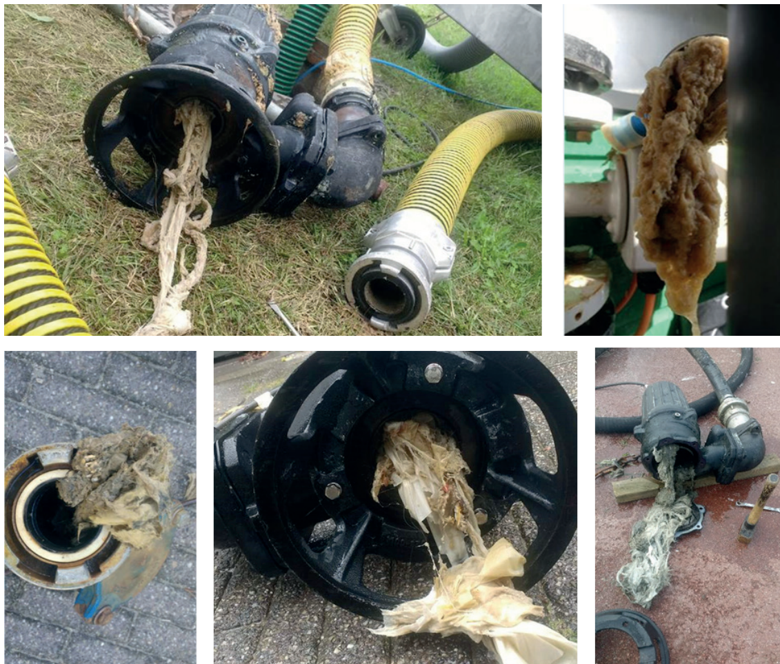
FIGUUR 3.6 VERSTOPPINGEN VAN POMPEN DOOR DOEKJES EN ANDER ONOPGELOST MATERIAAL
