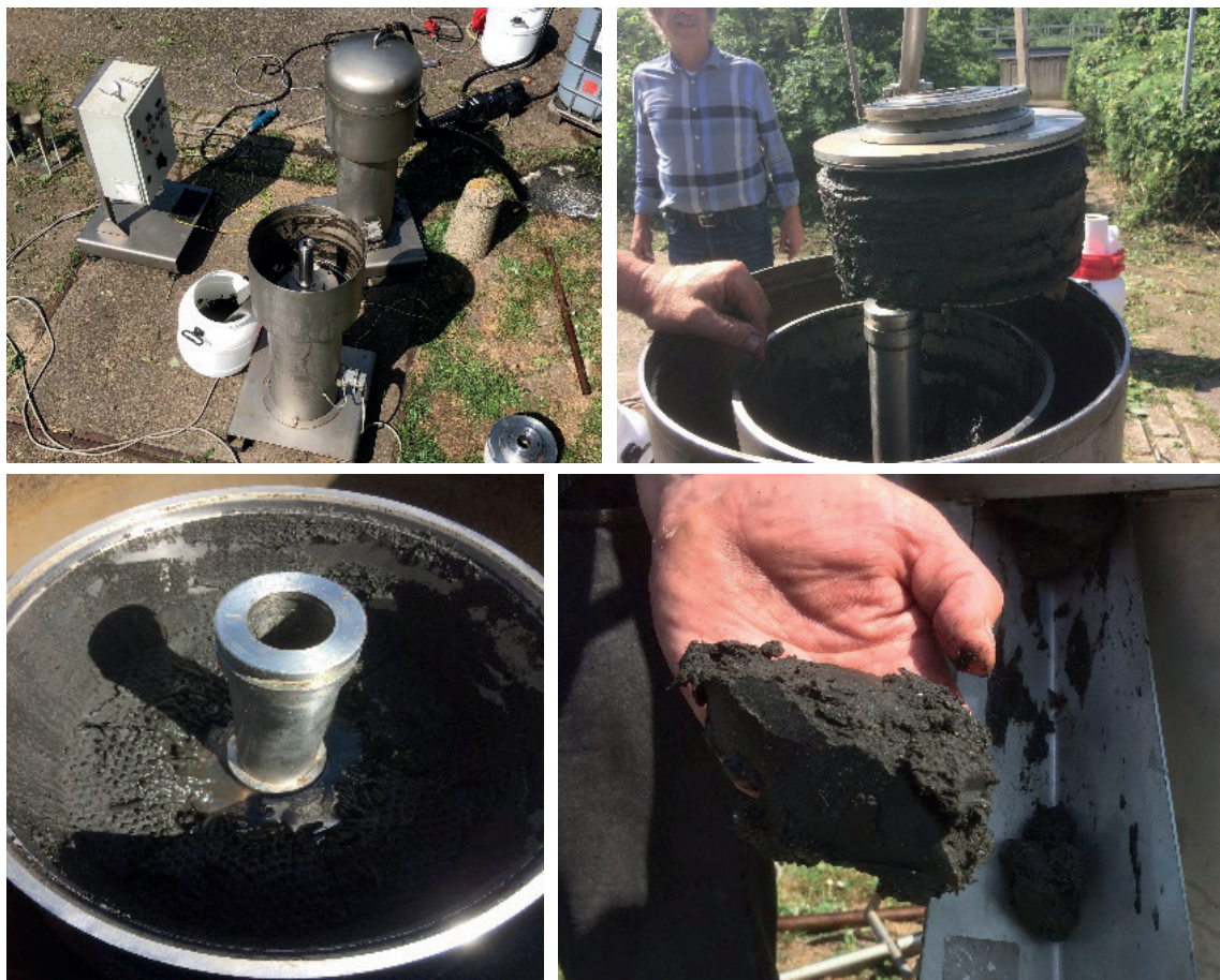
FIGUUR 3.1 DE BORSTELCENTRIFUGE OPSTELLING IN NIEUWE WETERING, V.L.N.R. OVERZICHT PROEFOPSTELLING BORSTELCENTRIFUGE INSTALLATIE, HET SLIB IN DE BORSTEL, INGEDIKT SLIB IN DE TROMMEL EN HET EINDPRODUCT UIT DE TROMMEL (FOTO'S: PETER LAAN EN HANS NIEUWENHUIS)
