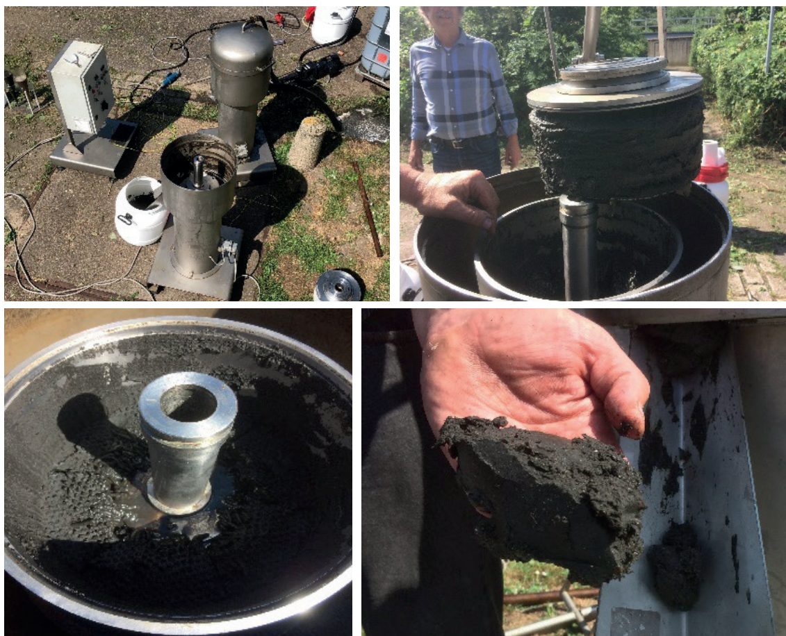
FIGUUR 3.1 DE BORSTELCENTRIFUGE OPSTELLING IN NIEUWE WETERING, V.L.N.R. OVERZICHT PROEFOPSTELLING BORSTELCENTRIFUGE INSTALLATIE, HET SLIB IN DE BORSTEL, INGEDIKT SLIB IN DE TROMMEL EN HET EINDPRODUCT UIT DE TROMMEL (FOTO'S: PETER LAAN EN HANS NIEWENHUIS)
