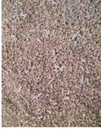
Pellets van steekvast ijzerslib gebruikt als filtermateriaal voor fosfor (bron: waterportaal)
