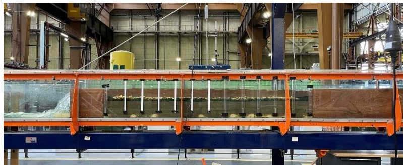
Figuur 9 Opstelling zanddoorlaatbaarheid proef
