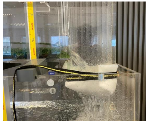
Figuur 25 Filterconstructie voor wegingen
