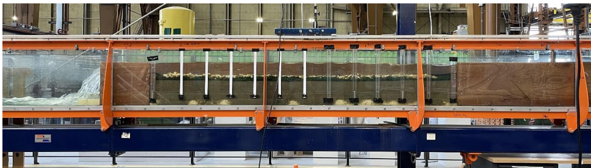
Figuur 3 Opbouw stroomgoot met snelheidsmeter
