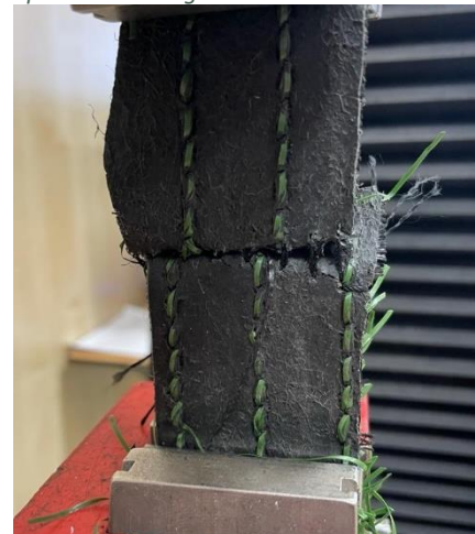
Figuur 18 Monster voetbalkunstgras stikrichting met de trekkracht mee
