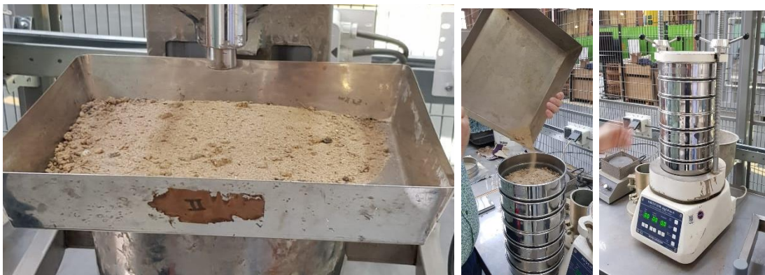
Figuur 5 Droge zeef test opstelling
