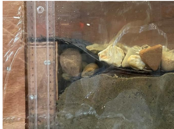
Figuur 10 Zandverlies einde testveld
