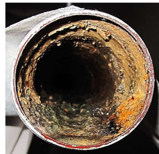
Materiaal: RVS Diameter: DN 50 Bedrijfstijd: 8 jaar
