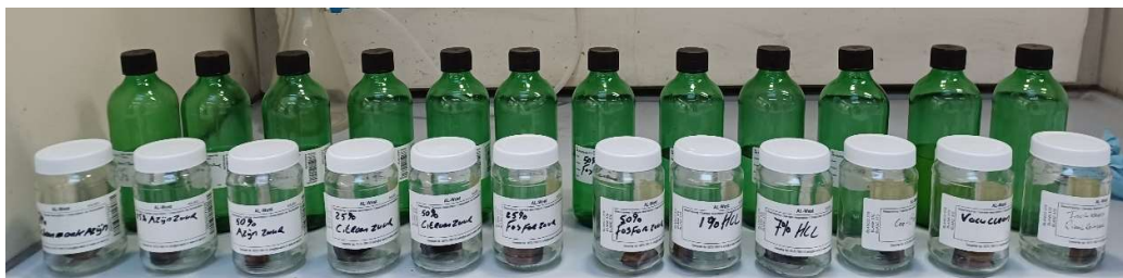
Figuur 2.2 Opzet van het experiment: volgorde van de potten, met daarin een stukje urinesteen
