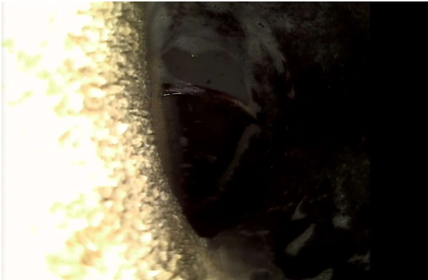
Figuur B1.7 Beeld direct na bocht voorgaande foto. Camera kwam niet verder. Op basis van luisteren op begane grond was hoorbaar dat de camera in de horizontale leiding in het plafond van de groepsruimte zat
