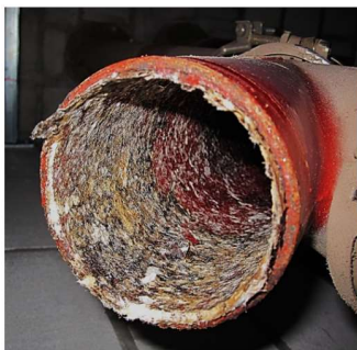
Materiaal: Gietijzer Diameter: DN 100 Bedrijfstijd: 5 jaar
