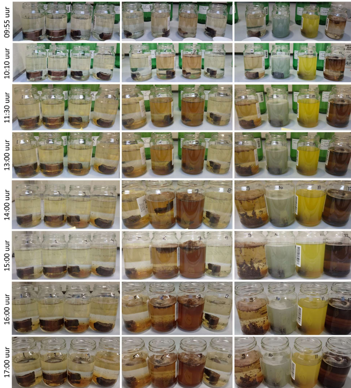
Figuur 3.2 Verloop van afbraak en/of oplossen van urinesteen op dag 1
