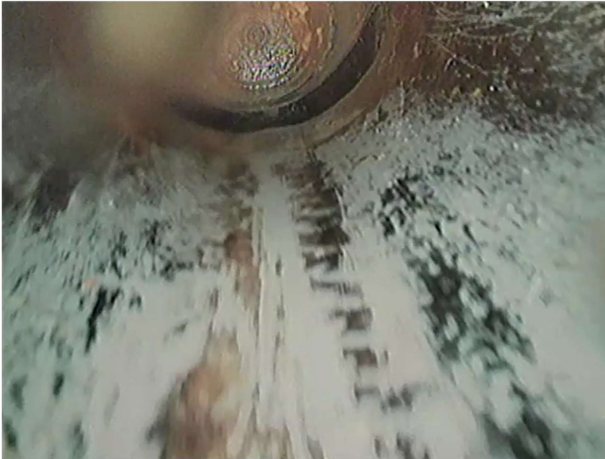
Figuur B4.13 Beeld net na zaagtand met op achtergrond ontstopningsstuk (flens) zichtbaar
