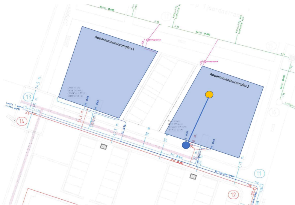
Figuur 2.1 Testopstelling t.b.v. chemische reiniging met Cee-Bee. Oranje bolletje weergeeft bij benadering locatie waar Cee-Bee wordt gedoseerd. Het blauwe bolletje weergeeft het inspectiepunt t.b.v. camera-inspectie waarbij de leiding (blauwe lijn) kan worden geïnspecteerd
