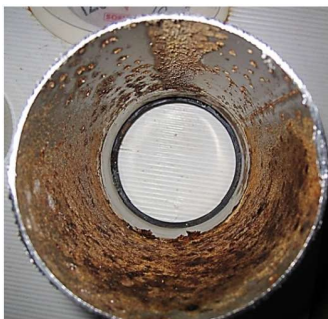
Materiaal: RVS Diameter: DN 70 Bedrijfstijd: 1 jaar
