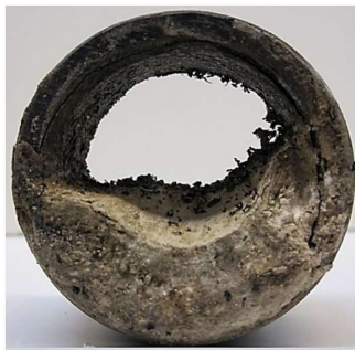
Materiaal: HDPE Diameter: DN 50 Bedrijfstijd: 12 jaar
