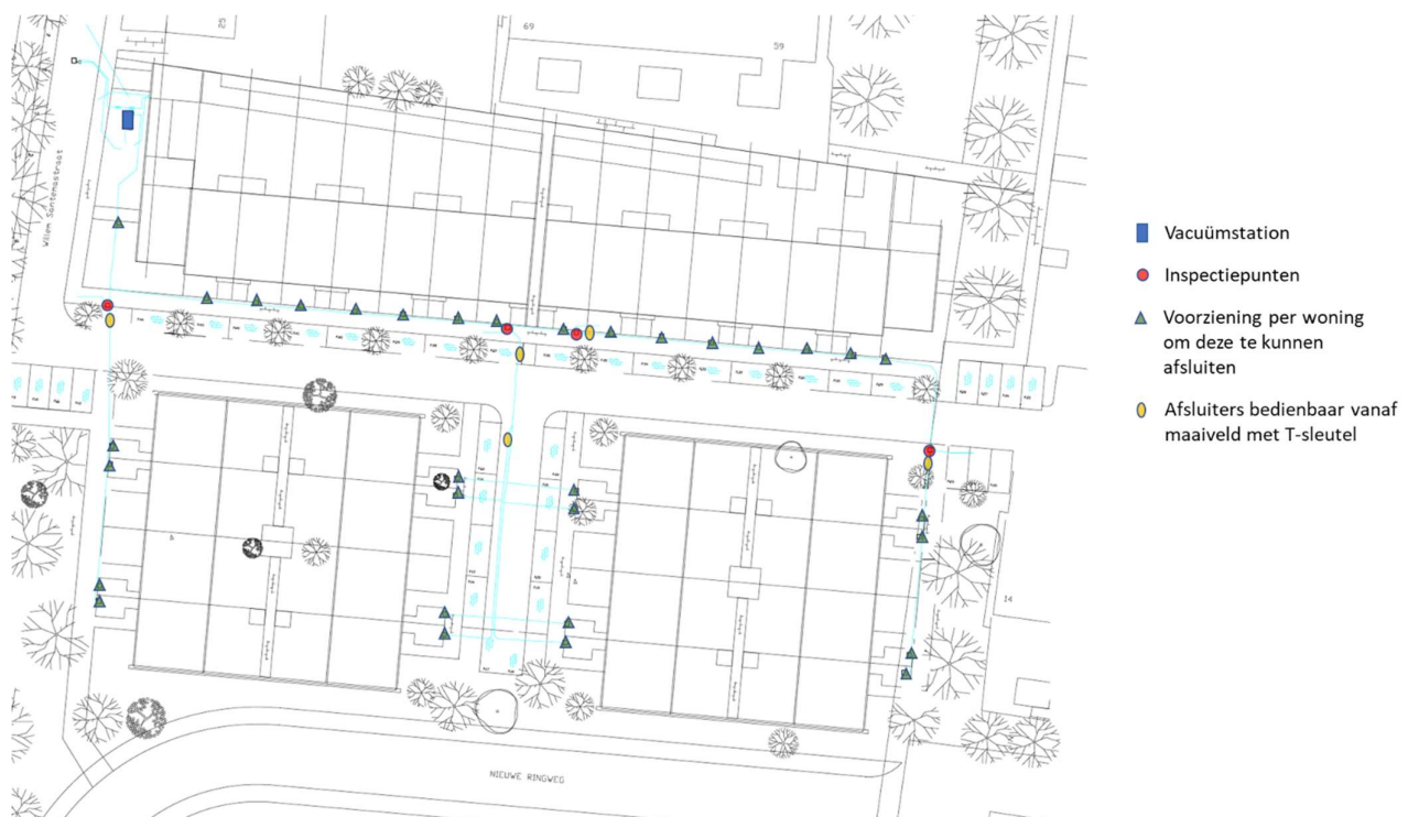
Figuur 2.1 Overzichtstekening vacuümriolering incl. aangebrachte voorzieningen
