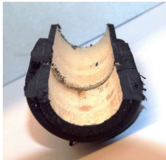
Materiaal: HDPE Diameter: DN 50 Bedrijfstijd: 7 jaar
