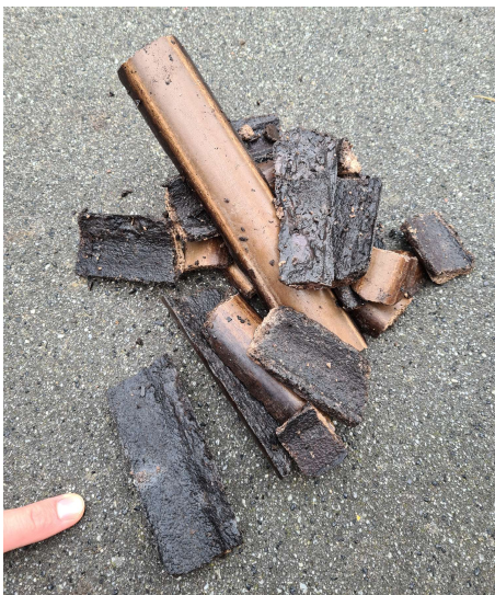
Figuur 4.9 Afzettingsmateriaal uit leidingdeel
