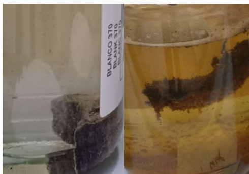
Figuur 3.3 Verandering van de structuur van urinesteen in 25 % fosforzuur. Links: Urinesteen direct na toevoegen zuur; rechts: Urinesteen na vier uur
