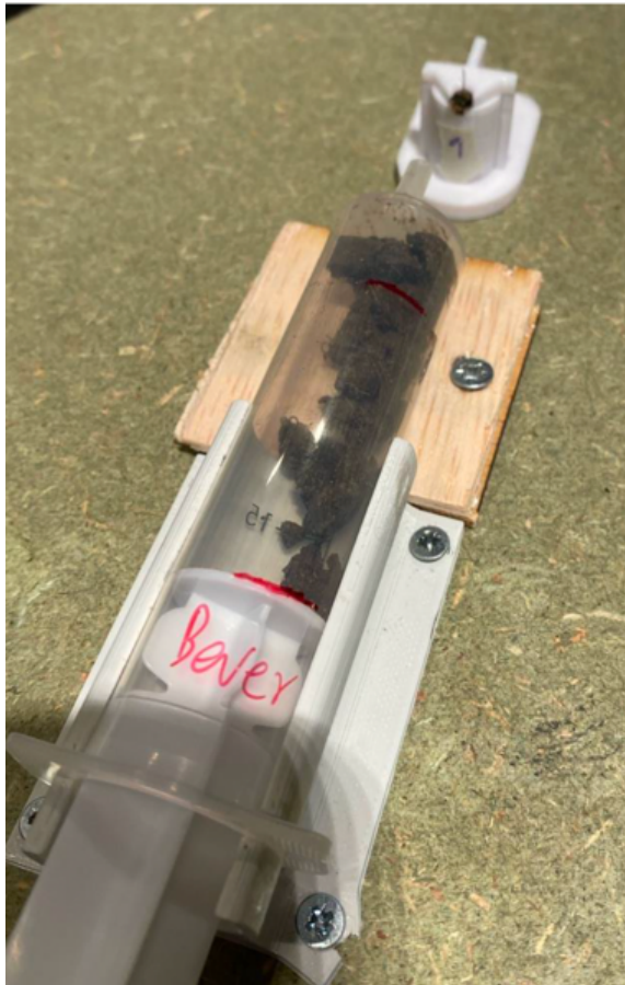
Figuur 2 Een spuit van 20 mL met het monster wordt op 2 cm van de honingbij geplaatst en gebruikt om de vluchtige stoffen toe te dienen
