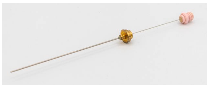
Figuur 2 Een foto van een SPME monsternemer. De fiber die de componenten uit de lucht opneemt zit in de naald en kan daaruit geschoven worden op de momenten dat een monster wordt verzameld of wordt geanalyseerd
