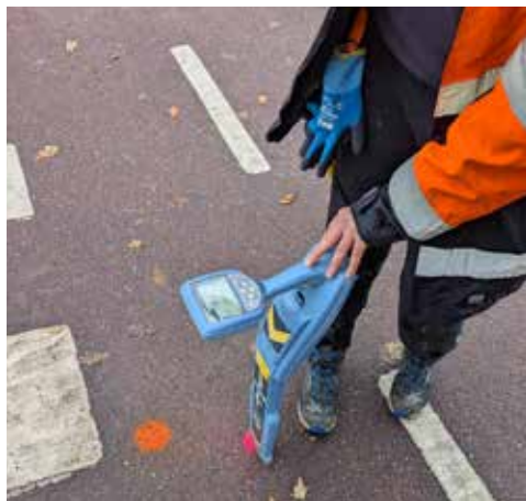
Figuur 3.7 Tracker waarmee de Acquarius bovengronds gevolgd wordt
