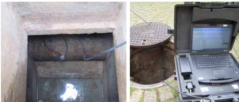
Figuur 3.2 Ontvanger op de persleiding (l) die gekoppeld is aan een computer om het passeren van de van de Smartball te monitoren (r).
