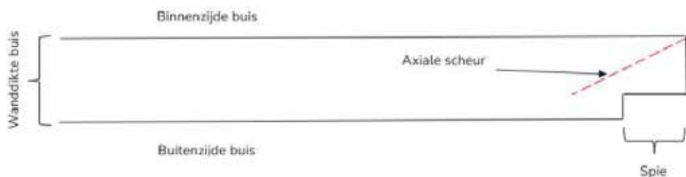
Figuur 4.34 Locatie van de axiale scheur bij het Croydonplein zoals gerapporteerd door Acquaint
