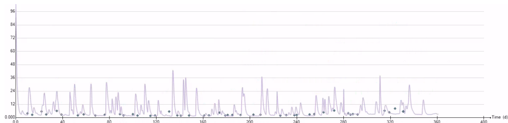
Figuur B4.19 De gemodelleerde Ntot-concentraties (groene lijn) en gemeten Ntot-concentraties (blauwe punten) in het effluent gedurende het gehele jaar van de derde simulatie van RWZI Winterswijk. De Ntot-concentraties zijn gegeven in mg N/l (y-as)
