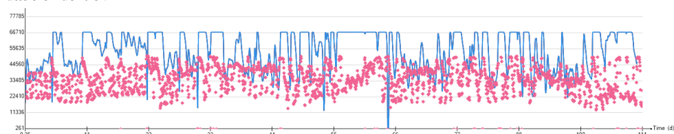
Figuur B4.10 De gemodelleerde beluchting (blauwe lijn) en gemeten beluchting (roze punten) in de beluchte omloop gedurende de eerste 106 dagen van de tweede simulatie van RWZI Winterswijk. De beluchting is gegeven in \text{m}^3/\text{dag} (y-as). De beluchting van slechts één van de vier beluchte compartimenten (010, 012, 013 en 014) is weergegeven. Ze zijn alle vier identiek
