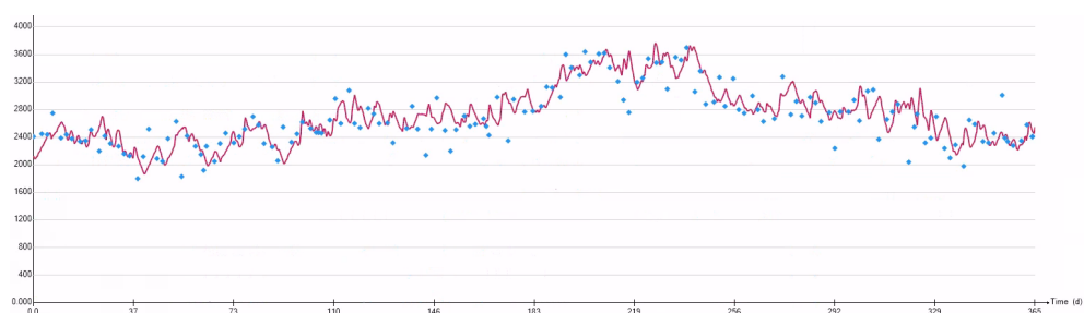
Figuur B3.42 De gemodelleerde TSS-concentraties (roze lijn) en gemeten OB-concentraties (blauwe punten) in de omloop (AC17) gedurende het gehele jaar van het gekalibreerde model van RWZI Hellevoetsluis. De TSS- en OB-concentraties zijn gegeven in mg/l (y-as)
