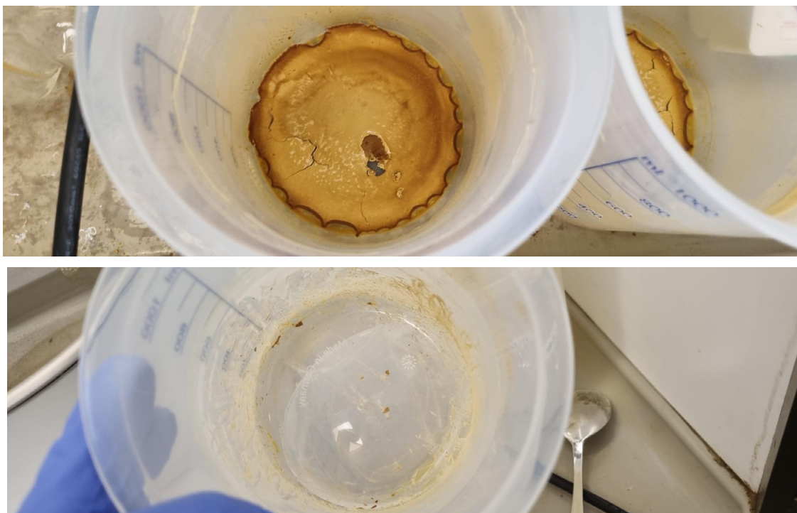
Afbeelding 4.5 Foto van de droge stof overgebleven in de maatbeker na het drogen in de oven
