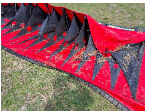
Figuur 2.85 Het gras werd rond drie weken van te voren gemaaid. Na de oefening bleek veel gras in de BFW te blijven hangen. Het schoonmaken ervan was heel arbeidsintensief.
