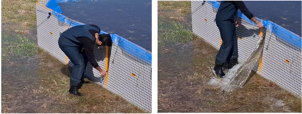
Figuur 2.70 De scheur verloopt over circa tweederde van de hoogte.
