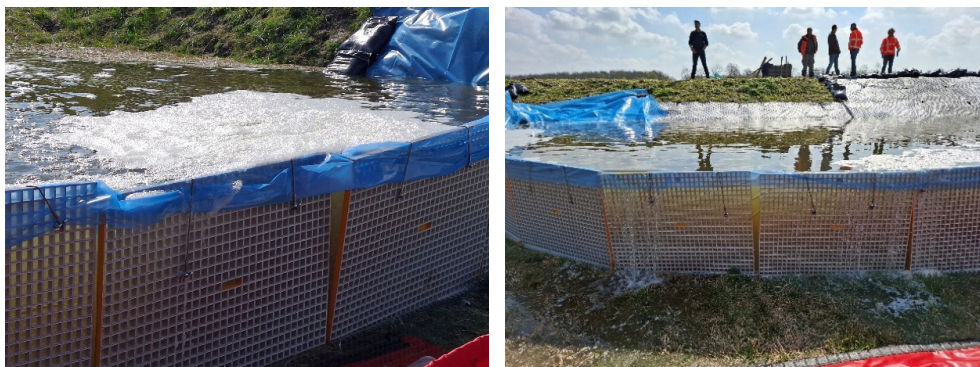
Figuur 2.63 Na het stopzetten van de wateraanvoer begint het Haawalbassin langzaam leeg te lopen.
