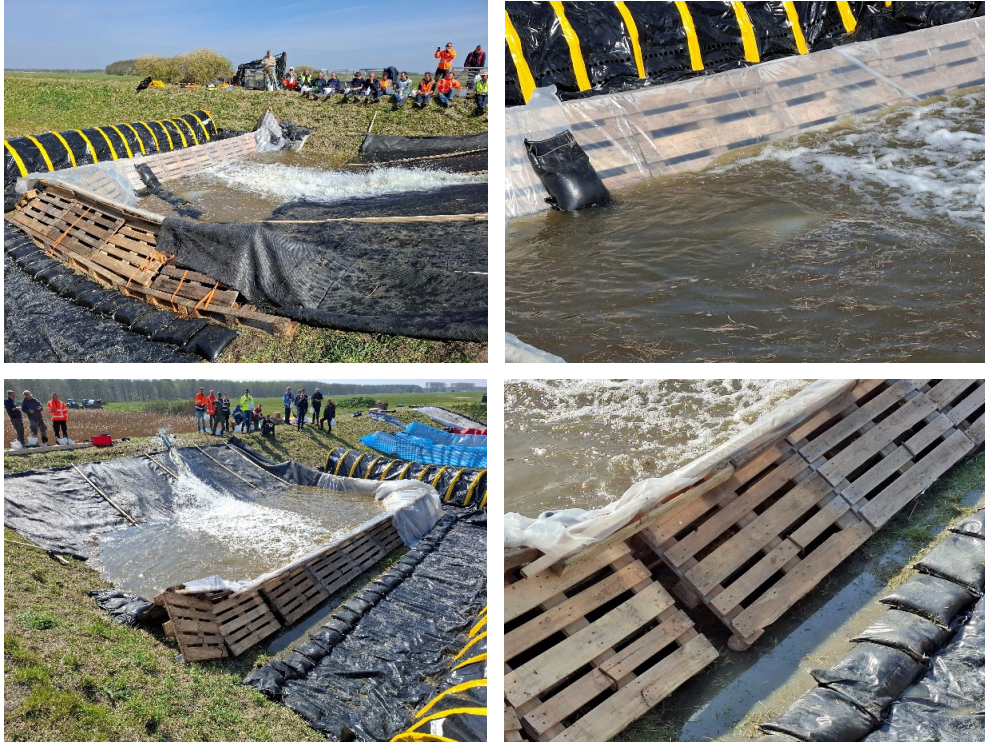
Figuur 2.33 Test van de Europalletbarrière op de tweede oefendag. De barrière heeft minder lekkage dan op de eerste dag.
