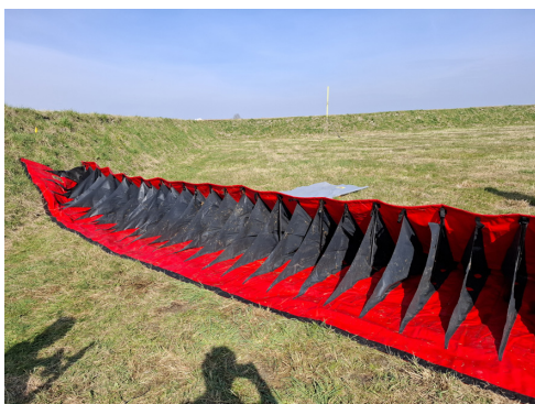
Figuur 2.81 Het BFW systeem wordt diagonaal in een van de hoeken van het bassin van talud naar talud geplaatst.
