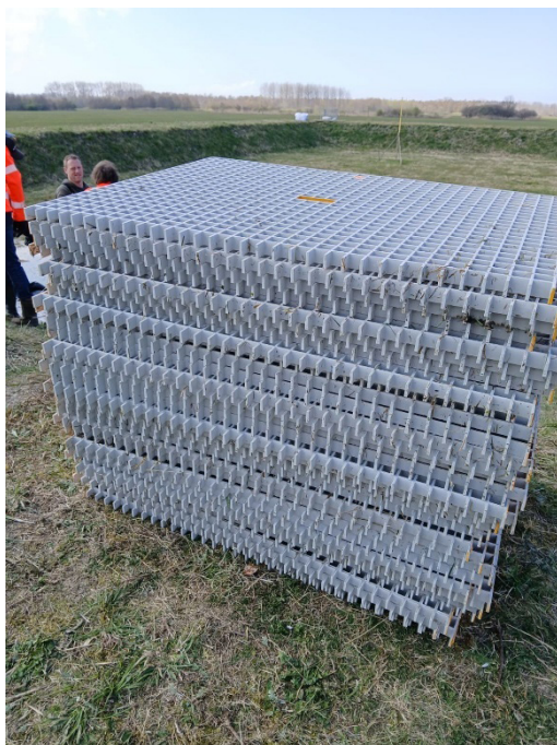
Figuur 2.51 In het midden van de modules is een opening om de modules makkelijk met één hand te kunnen dragen.
