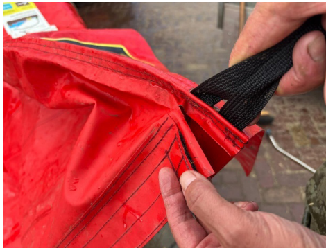
Figuur 2.88 Na gebruik in de oefening bleek de naad te zijn gescheurd.
