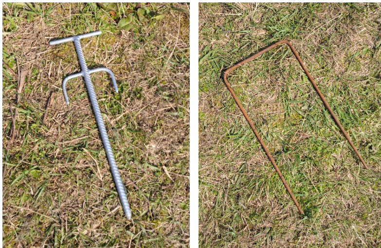
Figuur 3.6 Stalen T-pennen met een extra U-kram (links); U-kram (breedte 10 cm, lengte 30 cm diameter 8 mm) (rechts)
