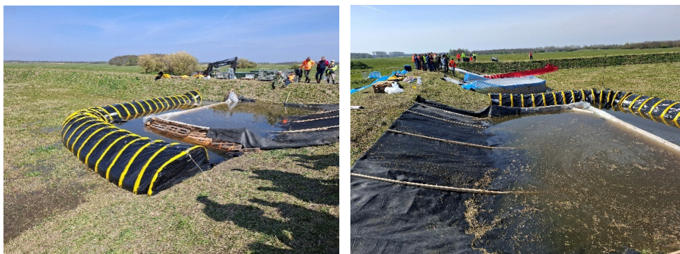
Figuur 2.35 Na het stopzetten van de watertoevoer blijft het water relatief lang op peil wat voor een goede waterdichtheid spreekt.
