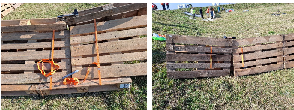
Figuur 2.14 Elke 3-pallet module wordt met spanbanden rondom samengehouden. Links: steunde kant, rechts: zelfde situatie gezien van de waterkerende kant.
