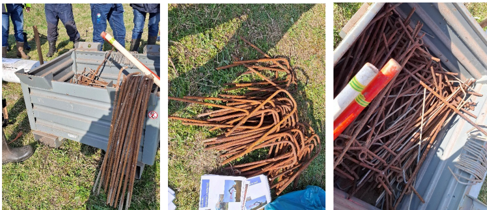
Figuur 3.3 Verschillende soorten stalen krammen en pennen. Links L-kram, midden U-kram en rechts Y-Pen
