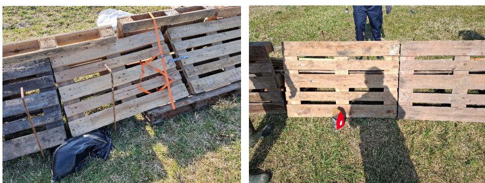
Figuur 2.19 Aan het 3-pallet systeem wordt een 2-pallet systeem in halfsteensverband aangesloten. Dit blijkt lastig vanwege de ontbrekende basispallet en de geringere systeemhoogte. Links: steunende zijde, rechts: waterkerende zijde.
