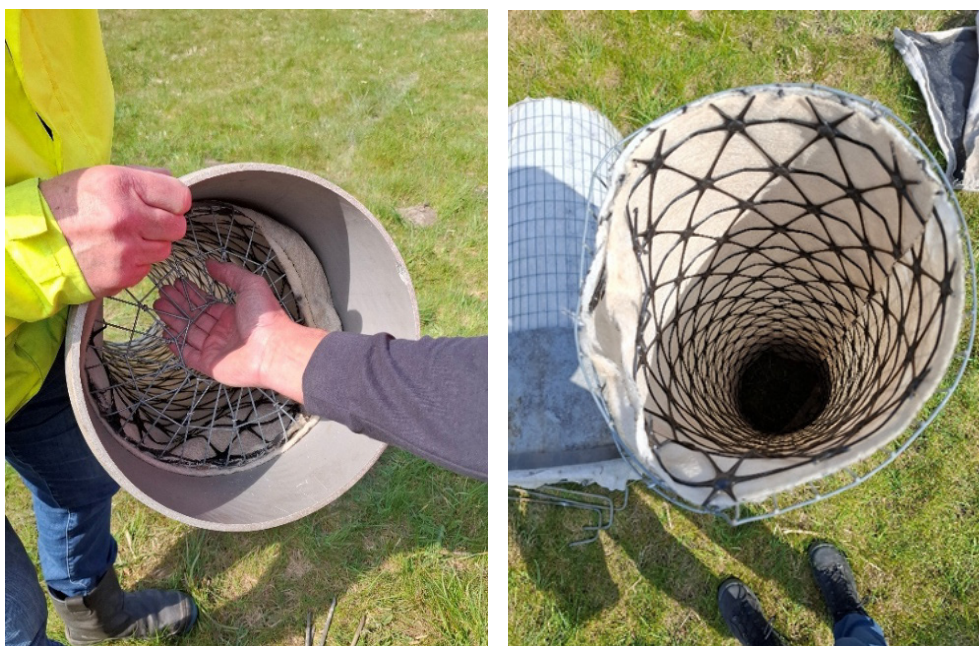
Figuur 4.8 De Wellenhoed bestaat uit een opgerolde Tensargeogrid dat aan de onderkant is omgevouwen waarbij een ronde opening vrij is gebleven.
