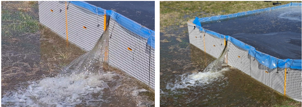
Figuur 2.72 Om de scheur af te dichten wordt een stuk folie aan de waterzijde tegen de twee verticale panelen geplaatst, wat tot een sterke reductie van de lekkage leidt.
