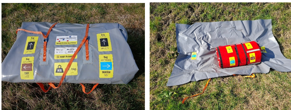
Figuur 2.74 Buitink Flexible Waterdam in originele hoes met werkinstructie op hoes en op module zelf.
