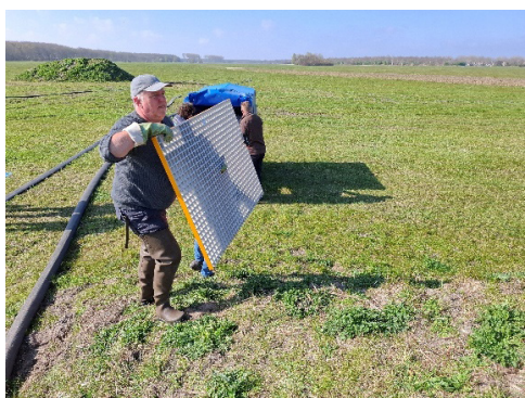
Figuur 2.51 In het midden van de modules is een opening om de modules makkelijk met één hand te kunnen dragen.
