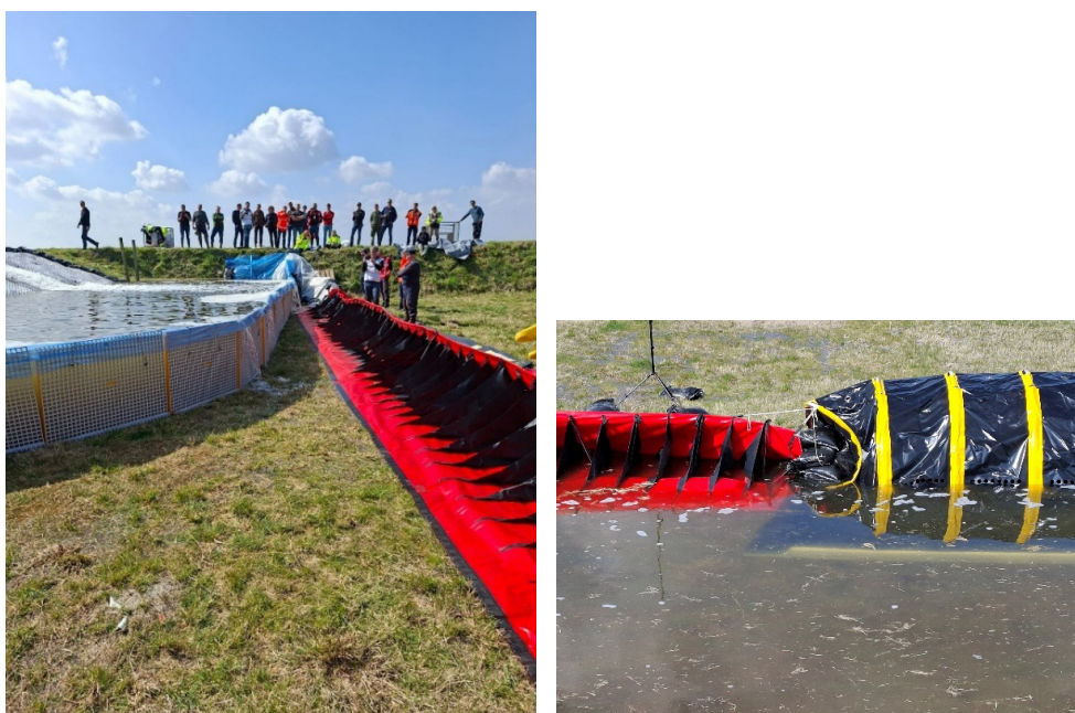
Figuur 2.79 Het gebied tussen Haawalbarrière en Buitink Flexible Waterdam (BFW) loopt vol met water.
