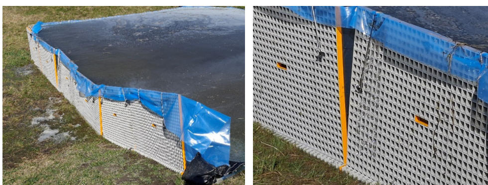
Figuur 2.68 Na het stopzetten van de watertoevoer houdt het systeem de waterstand lange tijd op peil. Het systeem is zeer vormstabiel. Er ontstaat geen probleem daar waar de panelen niet goed op elkaar aansluiten en een spleet zichtbaar is.
