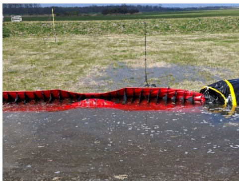
Figuur 2.80 Aan de achterkant van de BFW treedt lekwater als gevolg van onderloopsheid uit. De voorkant van de BFW is niet met zandzakken geballast waardoor het zeil gedeeltelijk opdrijft en er water onderdoor gaat stromen.
