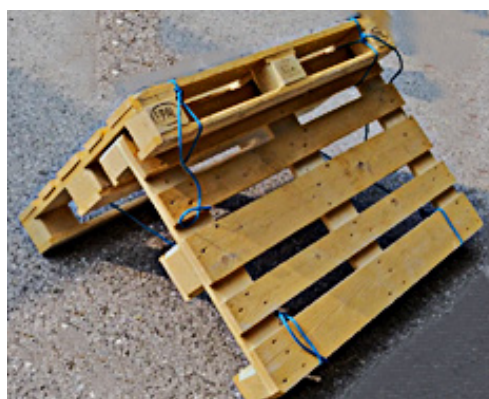
Alternatief kunnen de pallets ook met touwen of spanbanden worden gestabiliseerd.
