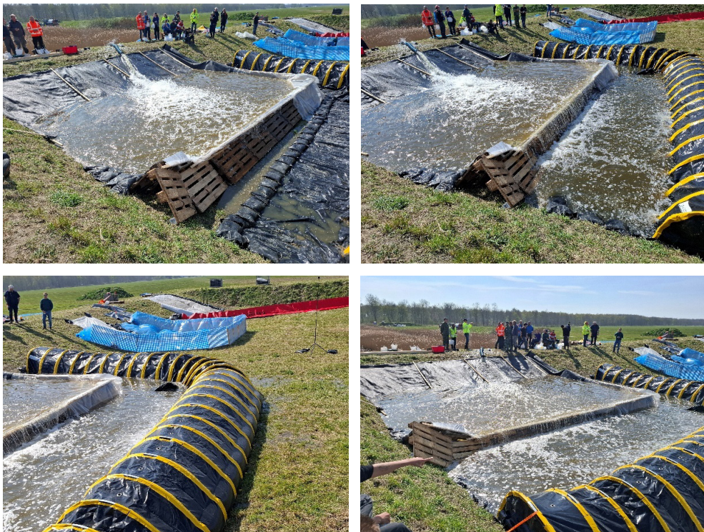
Figuur 2.34 Test van de Europalletbarrière op de tweede oefendag. Overstromen van de barrière verloopt zonder problemen. Geen stabiliteitsverlies of verplaatsingen.
