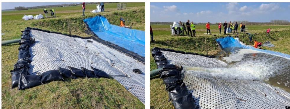
Figuur 3.17 Testen van de Tensarbekramming met overstromend water
