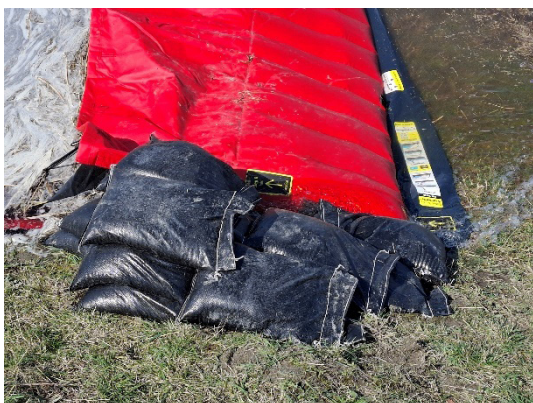
Figuur 2.83 Ook hier treedt onderloopsheid op. Een deel van het water stroomt ook langs de randen, die met zandzakken zijn afgedicht.
