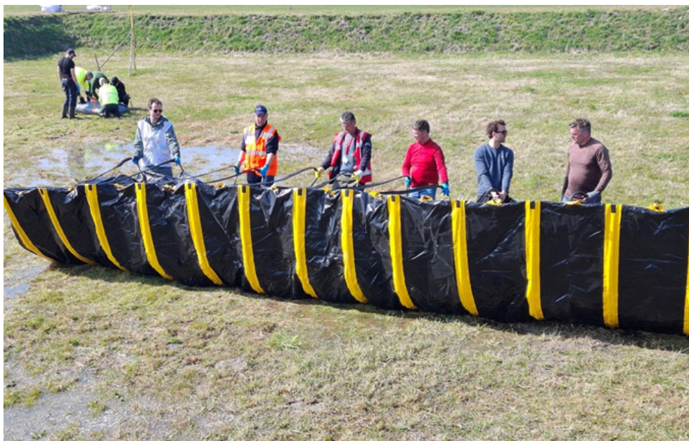
Figuur 2.45 Na afloop van de test werd het TubeBarriersysteem weer gedemonteerd. Daar was veel hulp bij nodig omdat het water er eerst volledig uit moest worden gelaten.
