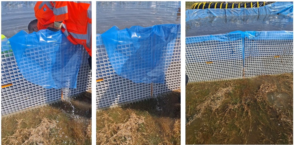
Figuur 2.72 Om de scheur af te dichten wordt een stuk folie aan de waterzijde tegen de twee verticale panelen geplaatst, wat tot een sterke reductie van de lekkage leidt.
