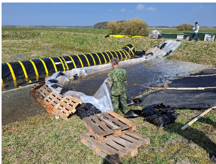
Figuur 2.32 Het bassin van Europallets na het stopzetten van de wateraanvoer. Het peil van het water in het bassin is na enige tijd vanzelf omlaaggegaan als gevolg van onderloopsheid en lekkage van de folie.
