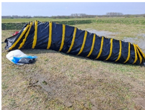
Figuur 2.47 Om het restwater helemaal te kunnen lossen wordt de TubeBarrier onderste boven op een helling geplaatst
