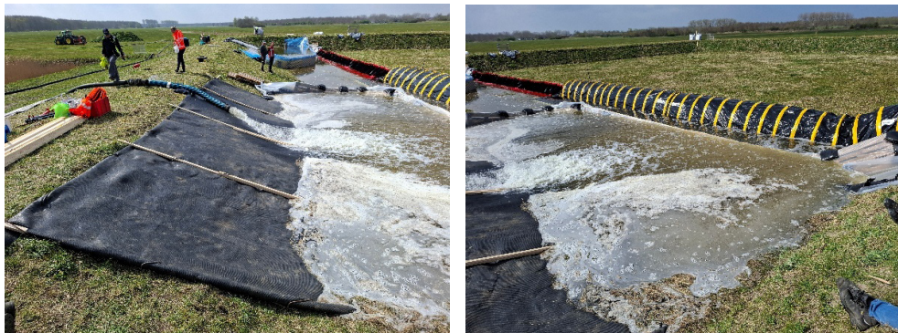
Figuur 2.31 Het bassin wordt verder gevuld zodat door het over de Europalletconstructie stromende water ook de tussenruimte met de daarachterliggende TubeBarrier wordt opgevuld, waarbij het water door de openingen aan de waterzijde van de TubeBarrier door stroomt en de tube met water vult.
