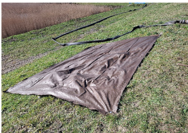
Figuur 3.2 Biodoek met schroeven aan de hoeken in de grond gefixeerd. Hiervoor worden normaliter houten pennen toegepast.
