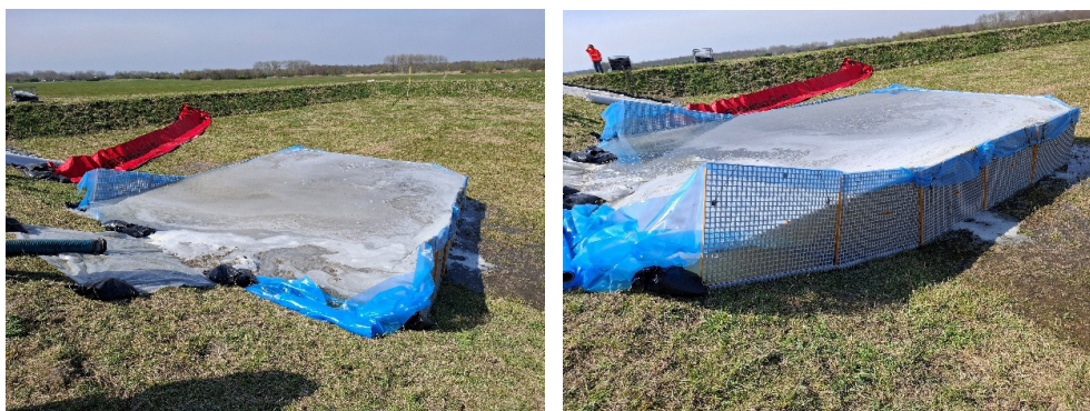
Figuur 2.68 Na het stopzetten van de watertoevoer houdt het systeem de waterstand lange tijd op peil. Het systeem is zeer vormstabiel. Er ontstaat geen probleem daar waar de panelen niet goed op elkaar aansluiten en een spleet zichtbaar is.
