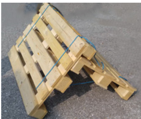
Alternatief kunnen de pallets ook met touwen of spanbanden worden gestabiliseerd.
