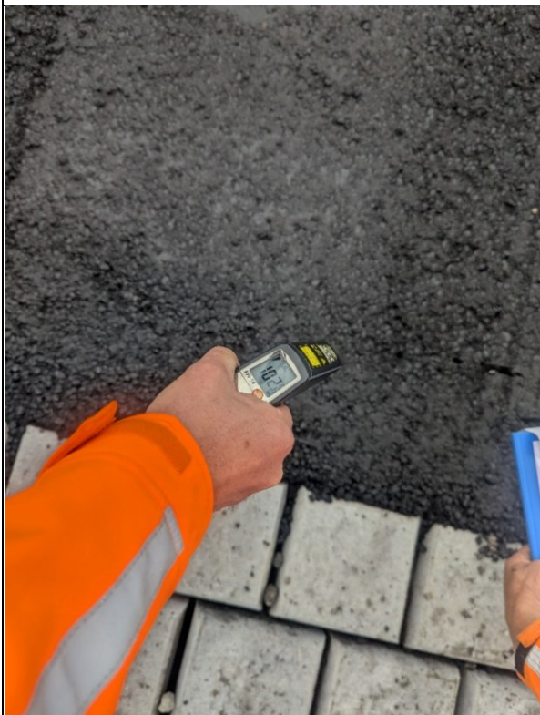
Figuur 7 Meting van de oppervlaktetemperatuur met infrarood
