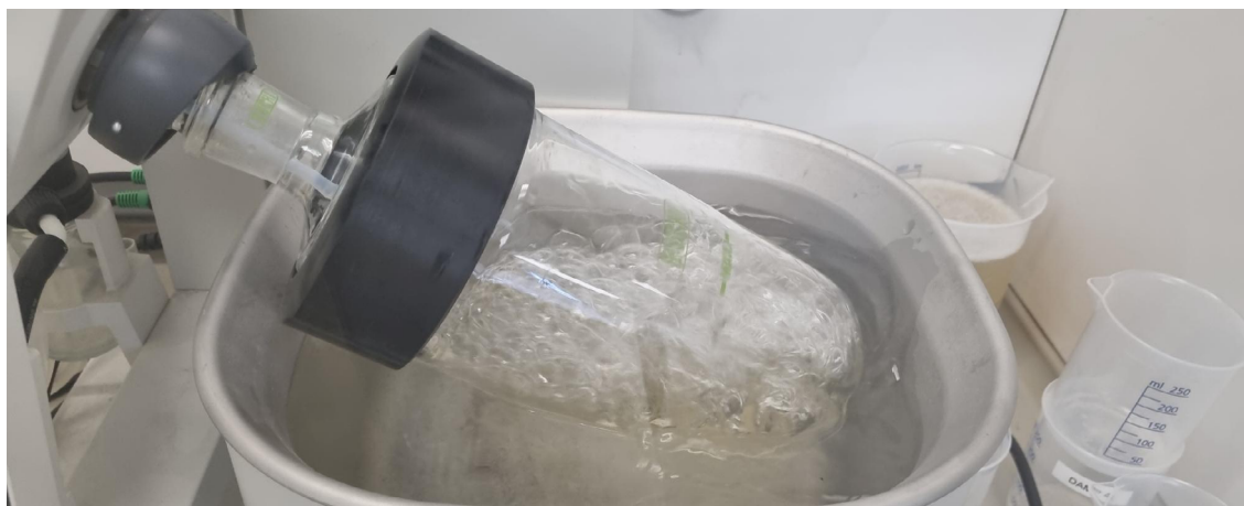
Afbeelding 3.5 Schuimvorming door PFAS in de verdampingskolf tijdens het indampen
